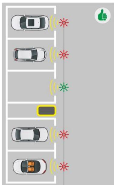
Датчики устанавливаются в проезде. Такое размещение позволяет обнаруживать присутствие автомобиля на парковочном месте и обеспечивает беспрепятственную видимость индикатора. Совмещение датчика с индикатором снижает стоимость материалов и работ на 30% по сравнению с датчиками с выносными индикаторами.
